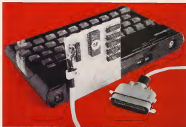
Mit dieser Interfacekarte kann der Spectrum an einem Epson-Metallzucker angeschlossen werden
